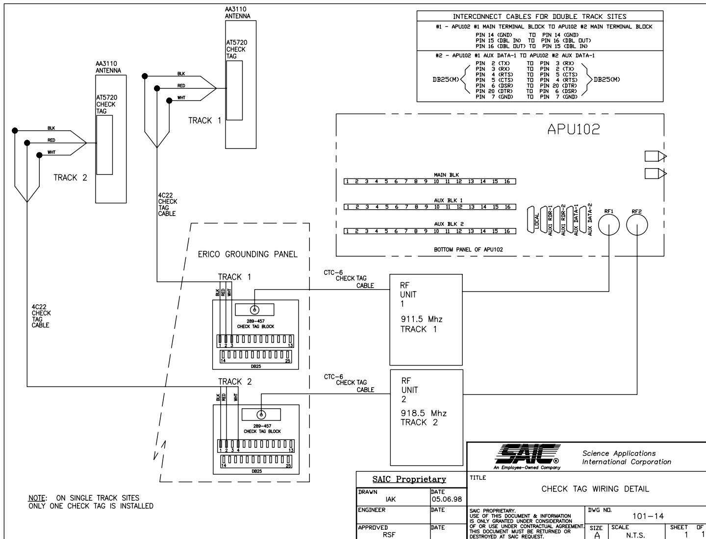
**Figure C.14: Check Tag Wiring Detail**
